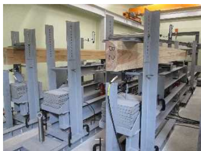
長期の変形を測定する クリープ試験機
