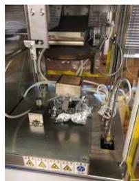
燃焼試験の結果、不燃性能を確認
