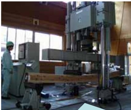
県産スギ材集成材の実大曲げ試験
