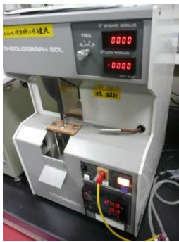
図1 粘弾性測定装置 (RHEOLOGRAPH SOL)
