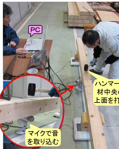
曲げたわみ振動法によるたわみにくさ(Eafb)の測定
