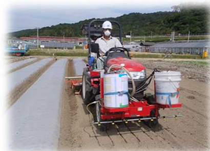
写真2 畝立・施肥・キルパー・マルチ同時作業による作業の省力
