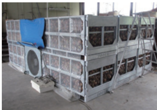
タマネギの簡易型強制通風乾燥 (左: ポリコンテナ 右: 大型コンテナ)
