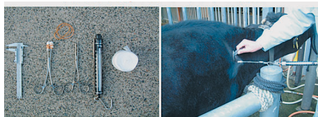
ノギス、鉗子、バネ秤、包帯、輪ゴムを用いて測定
