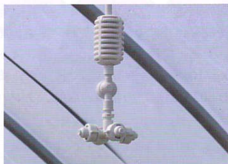
図1 試験に用いた細霧ノズル
