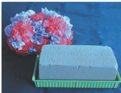
写真 フェノール発泡体を用いた生花のアレンジメント
