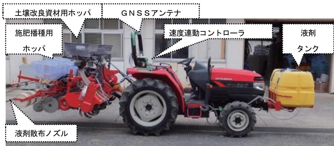
図1 GNSS速度連動土壌改良資材施用・施肥・播種・除草剤散布同時作業機
