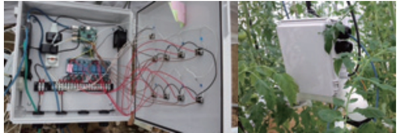
自作によるUECS制御装置(左)と環境測定装置(右)
