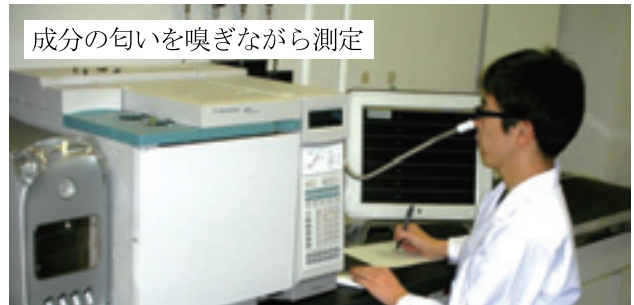
写真 におい嗅ぎガスクロマトグラフ質量分析計
