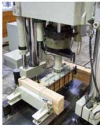
写真1 横架材端接合部のせん断試験
