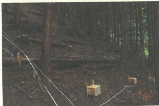
写真1 緊急防災林整備の土留工 (斜面下方に見えるのが調査用土砂受け箱)
