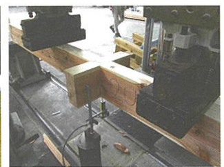
写真3 3等分4点荷重 (無加工材・かん合試験体共通)
