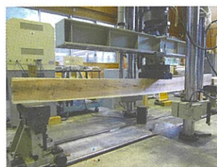
写真1 中央集中荷重 (無加工材の場合)
