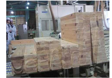
最大で梁幅180mm、梁高さ600mm、長さ9mのTAPOS加工ができます
