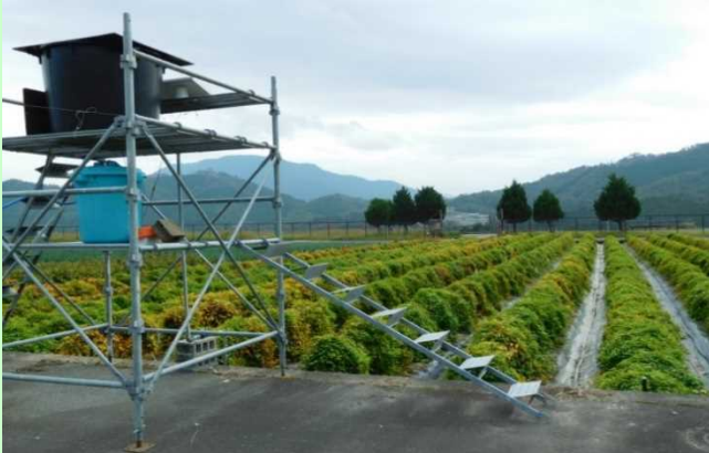
日射制御型拍動自動灌水装置の設置状況
