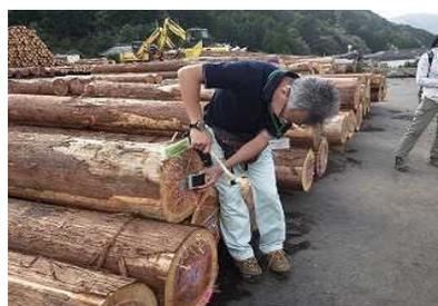
図4 新技術による強度測定
