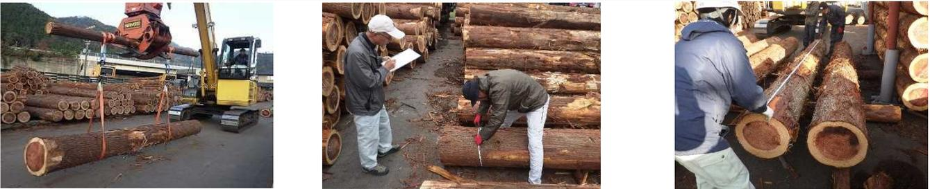
図1 密度の調査 重機吊上げによる重量測定(左)、木口断面積測定(中)、長さ測定(右)
