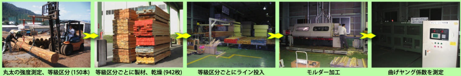
丸太の強度測定、等級区分 (150本) → 等級区分ごとに製材、乾燥 (942枚) → 等級区分ごとにライン投入 → モルダー加工 → 曲げヤング係数を測定
