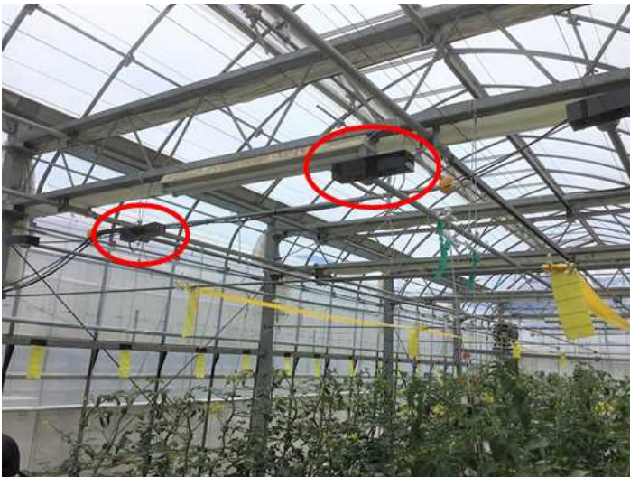
図1 磁歪材料による振動発生装置(東北特殊鋼株式会社製)をパイプに設置したトマト栽培施設(JA 全農内の展示圃場)
