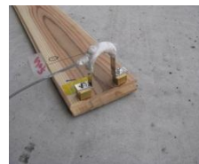
π(パイ)型変位計 によるリアルタイム測定
