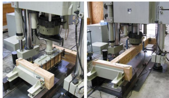
横架材端接合部の強度性能評価試験
