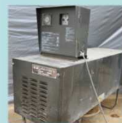
灯油燃烧方式炭酸ガス発生装置
