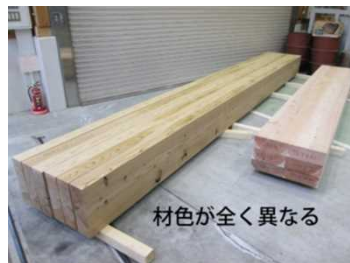
仕上げ後の 心持ち高温乾燥材(左)と 心去り天然乾燥材(右)
