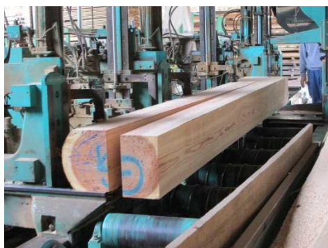
丸太から二本の平角材を切り出します。曲がりが発生するため、挽き直して通直にします。
