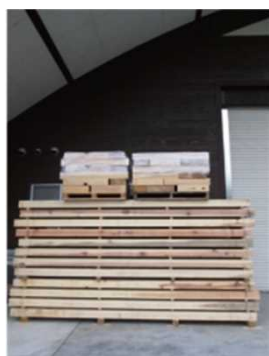
裏面(中心側)を上面とし、軒下で天然乾燥(約1.5年)
