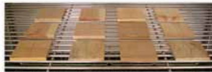
恒温恒湿器 20°C・65%で調湿→20°C・92%に制御(52日)→20°C・65%に制御(52日)
