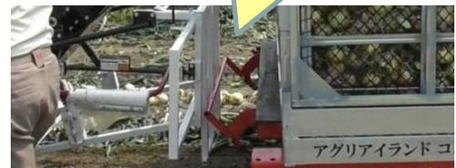
追従型運搬車は自動的にピッカーに追従していきます。
