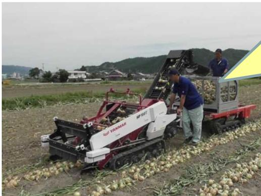
大型コンテナ対応の歩行型ピッカーと追従型運搬車を使って、大型コンテナに直接タマネギを収納していくことができます。
