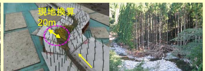
図5 湾曲溪流での災害緩衝機能の発揮の様子(左:水路実験、右:H21年災害現場)
