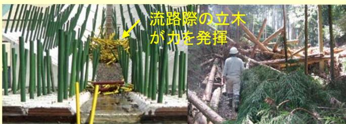
図4 直線溪流での災害緩衝機能の発揮の様子(左:水路実験、右:H21年災害現場)
