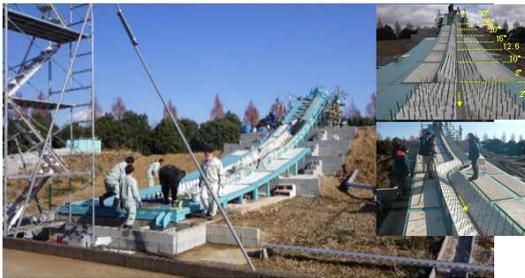
図1 1/30縮尺の実験水路(上:直線区間、下:湾曲区間)
