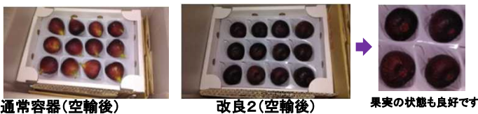
図3 振動試験(JIS Z 20232 L2)における果実の移動および損傷の割合
