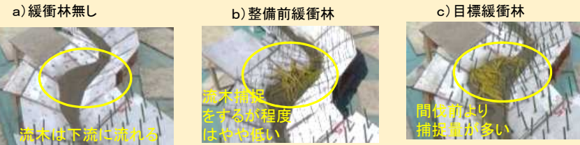
図9 湾曲溪流での緩衝林による災害緩衝機能の発揮(左: 緩衝林なし、中: 整備前緩衝林、右: 目標緩衝林)
