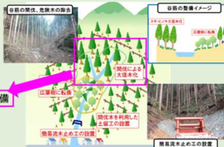
図4 緊急防災林整備(溪流対策)
