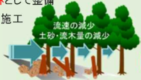
図3 災害緩衝機能を示す模式図
