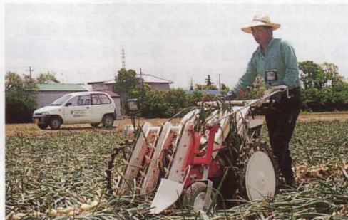
歩行型タマネギ収穫機の作業状況
