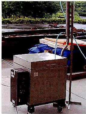
実験用炭化装置 温度設定ができ、酢液がとれる
