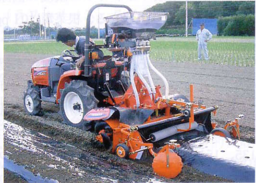
図1 小型乗用トラクター(13馬力)をベースにした畦内局所施肥同時マルチ張り機
