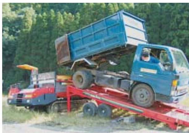
キャリアブリッジによるマニュアルスプレッダーへの堆肥の積み替え
