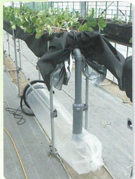
イチゴの株を冷やし、花芽分化の遅れを防ぐための送風装置
