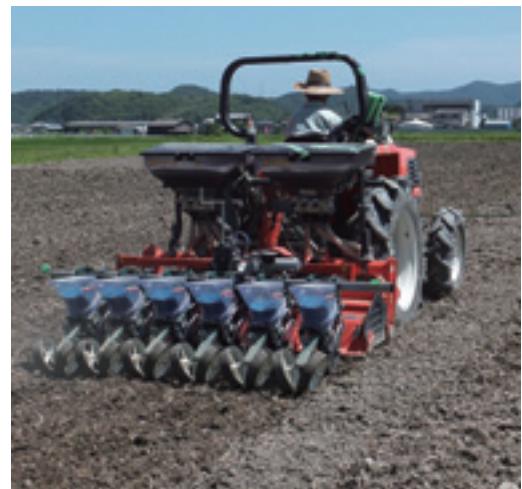
写真 「40粒/m 2 密播」用施肥播種機（目皿式なので1株2粒播種が可能）
