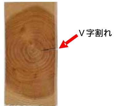
図1 心持ち平角材の長辺中央側面に発生する収縮異方性によるV字割れ
