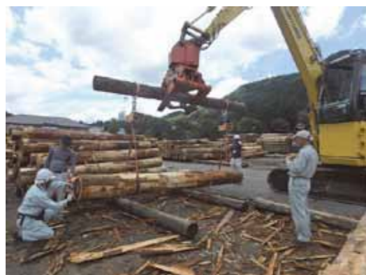
写真1 丸太の密度測定
