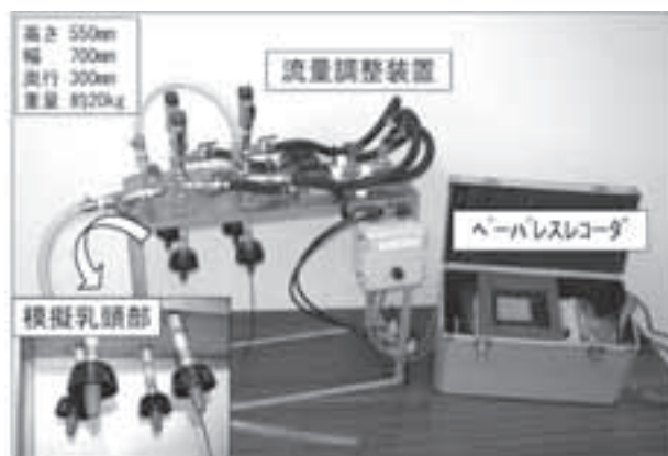
写真1 開発したクロー内圧測定装置
