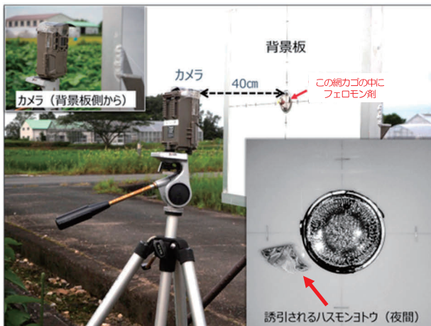
図1 センサーカメラとフェロモン剤の設置
