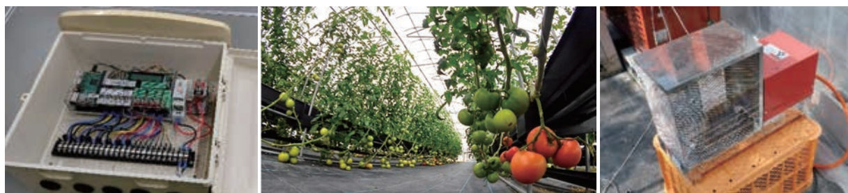
DIY型環境制御システム導入ハウスで栽培しているトマト（中央） 自作した環境制御ユニットの内部（左）と炭酸ガス施用装置（右）
