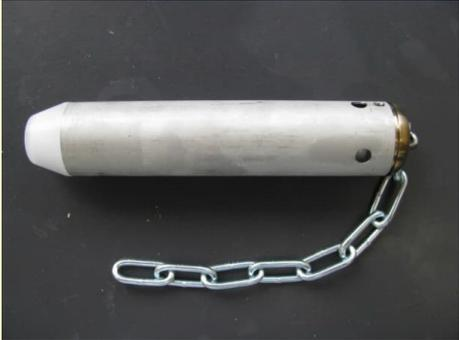
回収用の鎖 (磁性体) を取り付けした状態
