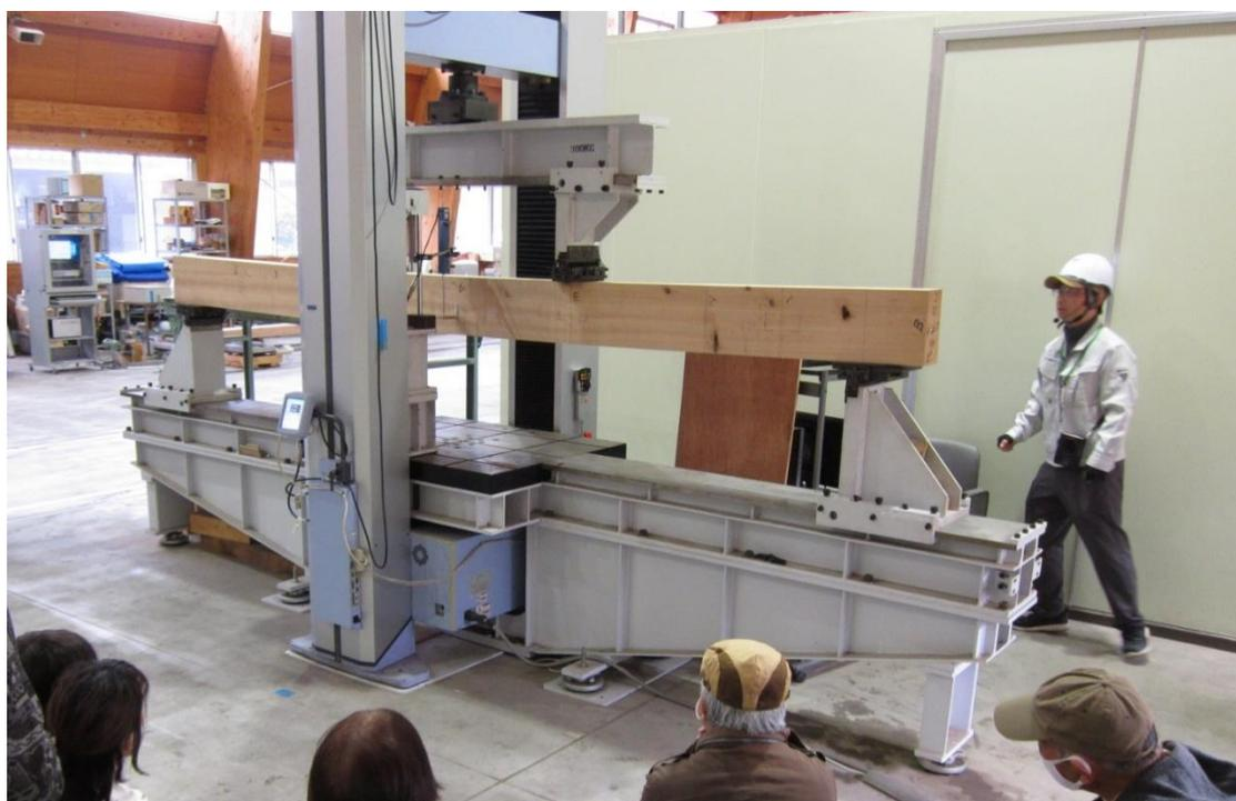
公開デーでの曲げ破壊試験の実演 (p23 参照)
