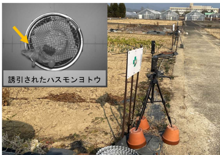
図2 赤外線センサーカメラの設置の様子と撮影されたハスモンヨトウ。
