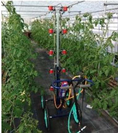
写真1 静電噴口ノズルと四輪カート
