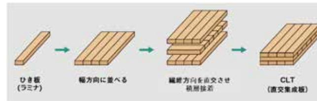
図 2 CLT パネル製造工程
