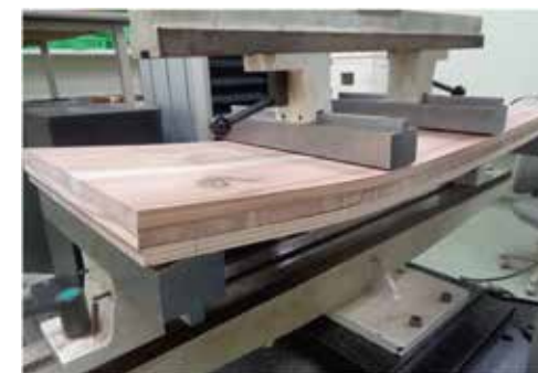
写真 1 製品の曲げ試験
