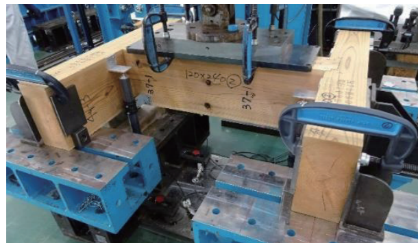
写真 横架材端接合部のせん断試験状況
